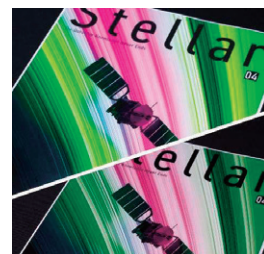
画像(上): CMYK・ピンク・グリーンの6色で印刷 画像(下): CMYKの4色で印刷
